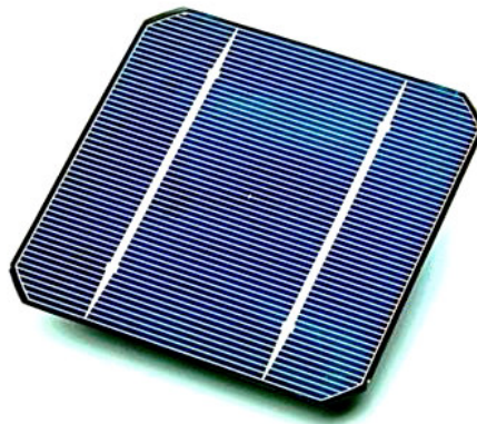
Cellule solaire pseudo carrée vue du côté N. On note la présence de la grille de collecte et de deux grosses électrodes verticales Source : DoE
